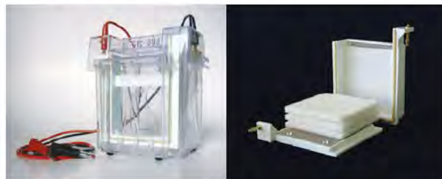
セイフティーセルミニ (泳動槽) STC-808
