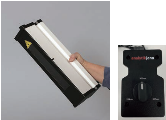
ダイヤルを回すだけで、波長を切り替えることができます。
