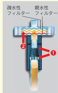
TC フィルター (セルフロックングフィルター) はドラモンド社ピペット・エイド® シリーズに共通してご使用いただける汚染防止フィルターです。
