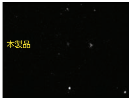
NanoSight LM10 (NanoSight 社) を用いて、エクソソームサイズの粒子を測定した。本製品ではエクソソームがほとんど除去されていることが分かる。
