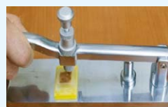
1. ドナーブロックを Main body に置き、Punch tip で組織スポットを切り出す。
