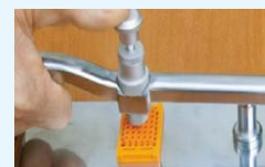
2. Punch tip の上部を押し込み、切り出した組織スポットを TMA cassette に挿入する。
