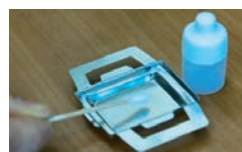
3. Base mold に Water glue をまんべんなく塗布する。
