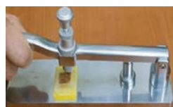
1. ドナーブロックを Main body に置き、Punch tip で組織スポットを切り出す。
