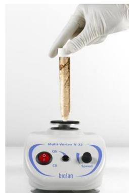
\* インパルスモードは、操作パネルの**QS**(Quick shaking mode) / **CS**(Continuous shaking mode) スイッチを**QS**(Quick shaking mode)に設定し、中央の黒いボタン(**QSボタン**)を押している間だけ作動するモードです。**CS**に設定すると**連続作動モード**となります。
